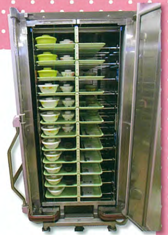
再加熱用カート(中央部の仕切り左側は熱風、右側は冷風が吹き出す)
