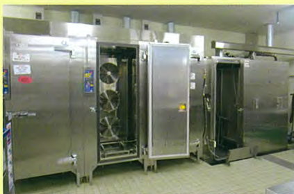
ニュークックチルには必須の大型冷却機「プラストチラー（左～中）」「真空冷却機（右端）」
